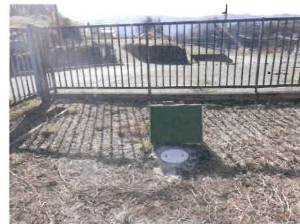
地下水観測孔の例
